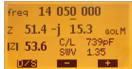
Bild 19: Einzelfrequenz-Messung Impedanz
