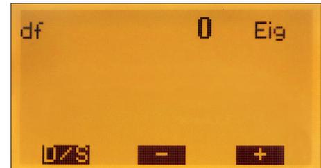
Bild 29: Eingabemöglichkeit für den Korrekturbetrag der Frequenz
