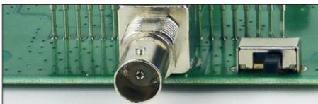
**Bild 8:** Schiebeschalter in Stellung Aus
