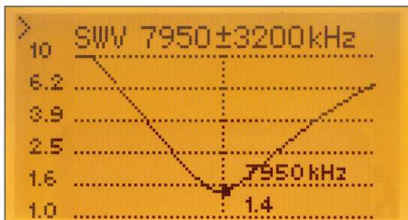
Bild 21: Einzelner Durchlauf zur SWV-Messung
