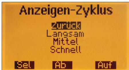
Bild 30: Der Anzeigenzyklus kann *langsam*, *mittel* oder *schnell* gewählt werden.
