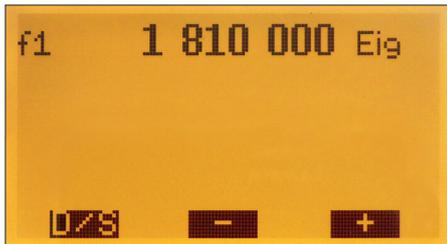
**Bild 26:** Einstellung der Frequenz  $f_1$ , rechts ist das Kürzel *Eig* zu sehen; betätigt man jetzt die Plus- oder Minustaste, wird der Frequenzwert für  $f_2$  angezeigt und kann verändert werden, ebenso gelangt man zu  $f_3$  usw.
