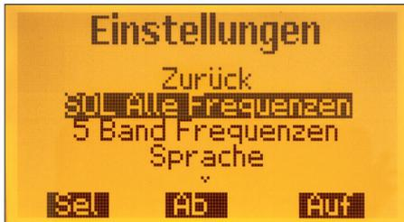
Bild 12: Die Master-SOL-Kompensation (für alle Frequenzen) wird im Untermenü *Einstellungen* gestartet.
