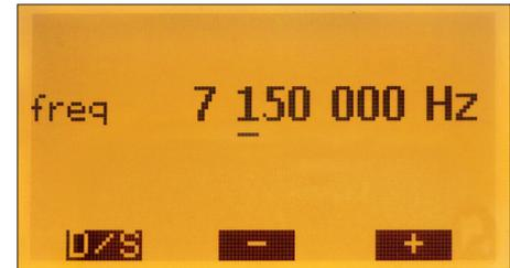
**Bild 24:** Displayanzeige beim Betrieb des FA-VA4 als HF-Generator; die Frequenz ist mithilfe der drei Tasten einstellbar.
