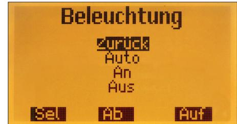
Bild 28: Einstellung der Displaybeleuchtung
