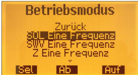
Bild 11: Menüpunkt zur SOL-Kompensation für eine Frequenz
