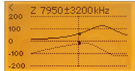
Bild 20: Einzelner Durchlauf zur Impedanzmessung
